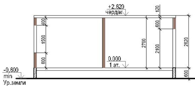
Схема разреза гаража.
